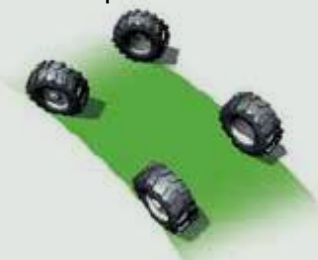
Mode 2 roues : essieu directionnel avant
