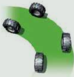
Mode 4 roues : essieux avant et arrière directionnels
