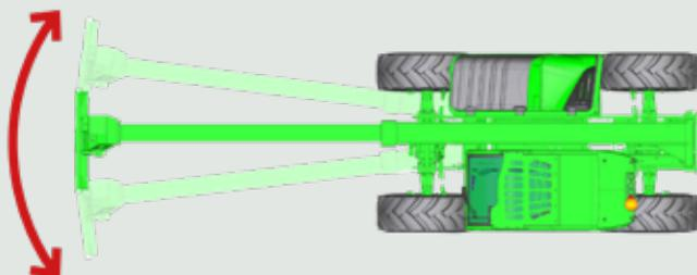
Système intégré dans le châssis de la machine (modèles Panoramic) qui permet un mouvement latéral de la flèche télescopique, assurant un positionnement précis de la charge sans avoir recours à d'autres manœuvres, ce qui permet de gagner du temps, d'éviter le stress et d'améliorer la productivité de la machine. La commande pour mettre la translation en œuvre est placée sur le joystick et est de type proportionnel pour maximiser son efficacité.
