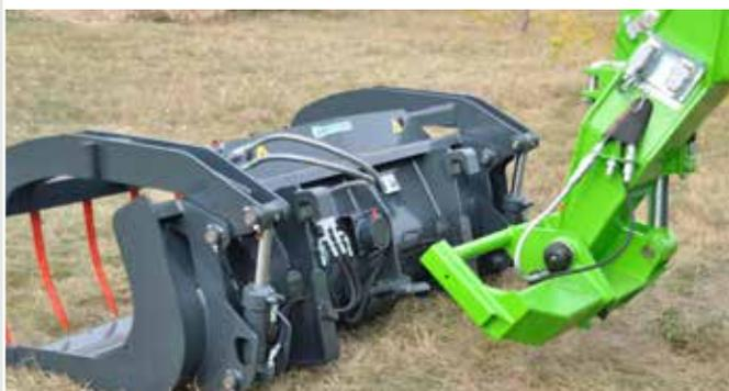
Le tablier des machines Merlo a été conçu pour garantir des performances inégalées avec chaque outil, sans pour autant compromettre la légèreté, essentielle pour garantir une capacité de levage record. La rotation maximale permet également un excellent chargement et déchargement des matériaux à l'aide d'un godet. Le dispositif **Tac-lock, de série** sur tous les modèles, assure un confort d'utilisation maximal en permettant le verrouillage hydraulique des outils depuis la cabine.
