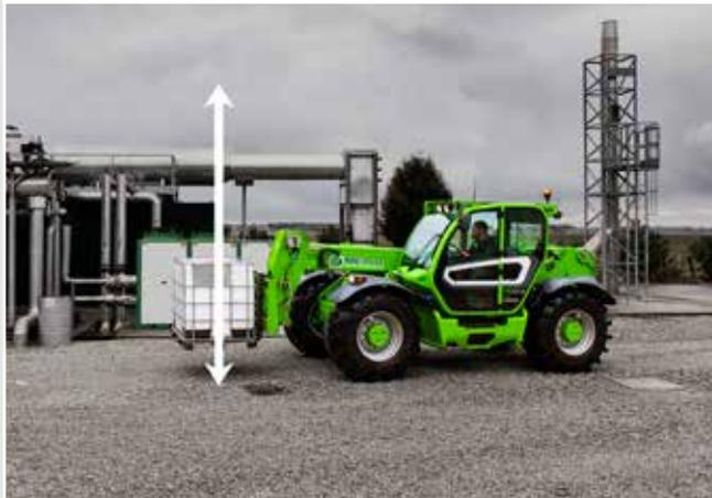
L'élévation verticale automatique a été développée afin de faciliter la manutention d'une charge dans des espaces confinés. En activant cette fonction, la machine synchronise les mouvements d'extension et de levage, afin d'obtenir un mouvement purement vertical de la charge pendant les phases de chargement et de déchargement des matériaux.
