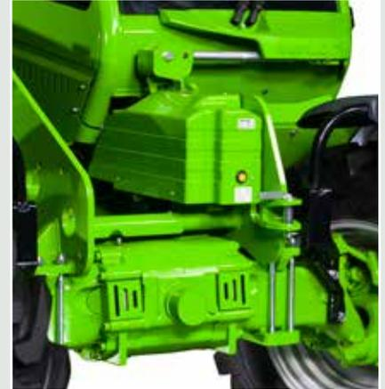
Pour augmenter l'efficacité et la durée de vie des batteries, les chariots télescopiques sont équipés, de série, d'un disjoncteur électrique et automatique de batterie. Le retrait de la clé du contact démarre le processus de déconnexion du circuit électrique de la machine. Lorsque le circuit est déconnecté, il suffit d'insérer de nouveau les clés dans le panneau de contrôle pour réactiver les batteries.
