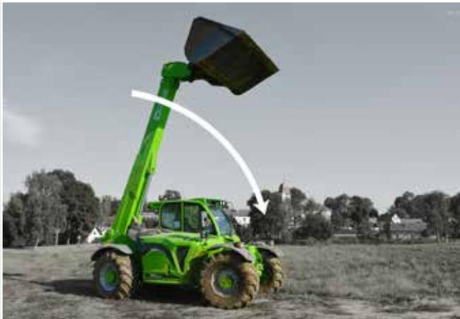
Cette solution, à actionnement entièrement automatique, permet d'exploiter le poids de la flèche et de la charge pour effectuer le mouvement de descente, en limitant considérablement la demande de puissance hydraulique et, par conséquent, la consommation et le bruit, sans réduire la sécurité. Des mouvements plus rapides et plus fluides permettent d'augmenter les performances.
