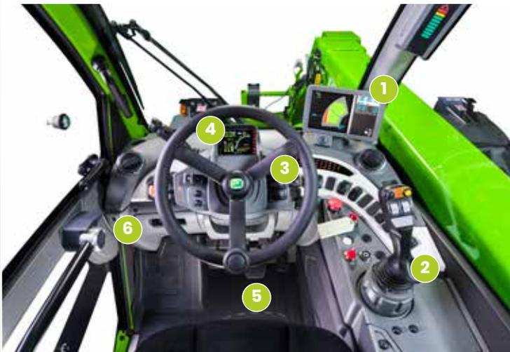
Une nouvelle conception privilégie la fonctionnalité et le confort, en regroupant les informations destinées au conducteur et les commandes des différents systèmes et dispositifs pour maximiser l'ergonomie. L'inverseur au volant est également dupliqué sur le joystick.
