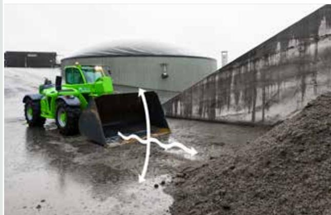
Disponible en option, la gestion flottante de la flèche a été développée afin d'augmenter la polyvalence de la machine, facilitant les opérations avec des accessoires appelés à suivre les tendances du terrain comme les balais-brosses, les lames à neige, les pelles, etc. En activant cette fonction, la flèche peut suivre librement les contours du sol, assurant un contact constant de l'outil avec le terrain.
