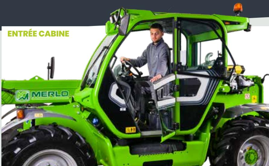
L'accès à la cabine est facilité par la **porte qui s'ouvre à 180°** et par la grande distance entre le montant et le volant, ce qui maximise l'espace d'entrée. La vitre latérale, indépendante du corps de la porte, peut être bloquée en position ouverte afin de maximiser l'échange d'air, la visibilité et le contact direct avec ceux qui travaillent à l'extérieur, à proximité de la machine.
