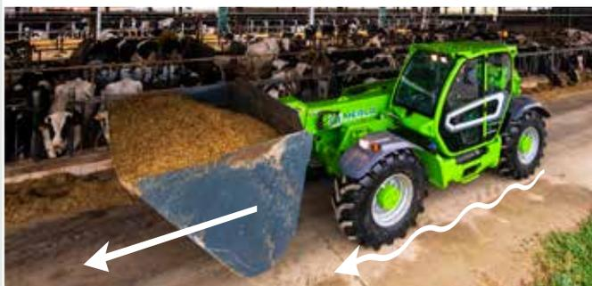
La suspension active de la flèche (BSS), de série pour les modèles HF, est disponible en option. Ce système protège la charge pendant les déplacements et maintient un confort de conduite élevé sur les terrains accidentés. La suspension est automatiquement désactivée à vitesse réduite (inférieure à 3 km/h), ce qui offre une précision et une force de manutention maximales.
