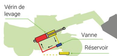
Les modèles HM sont équipés de série du système de régénération du circuit hydraulique pour une productivité accrue. Cette solution a été développée en vue d'augmenter la vitesse angulaire de la flèche lors de la manipulation et du transfert. Le système, à gestion entièrement automatique, est capable d'assurer une augmentation de 36 % de la vitesse de la flèche.
