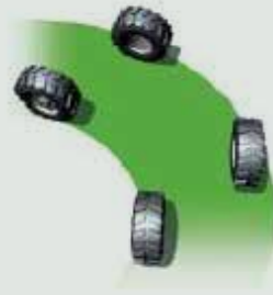
Mode 4 roues : essieux avant et arrière directionnels
