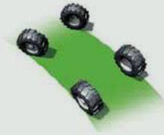
Mode 2 roues : essieu directionnel avant
